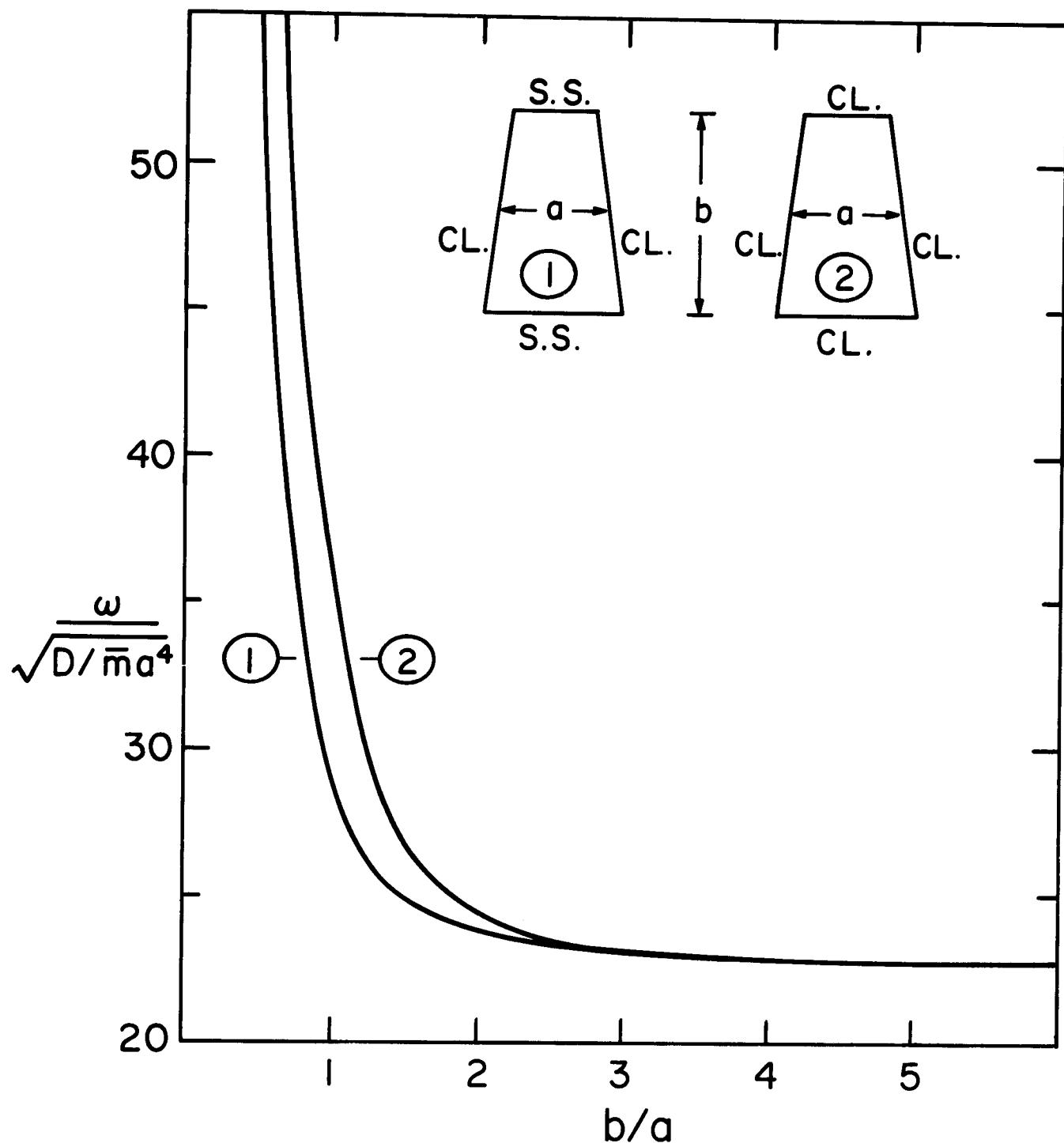
FUNDAMENTAL FREQUENCY VS. ASPECT RATIO
