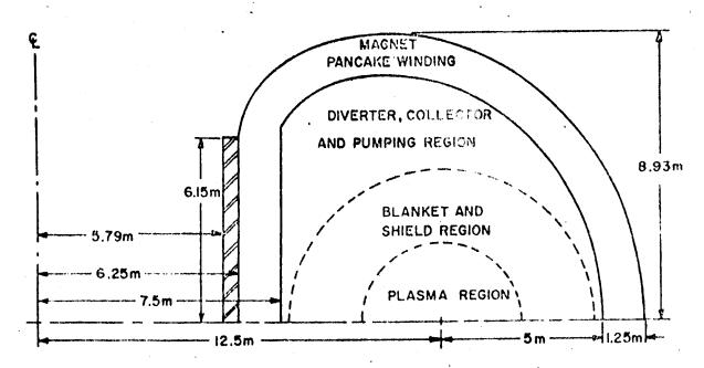
Fig. 3. Toroldal magnet cross section.
