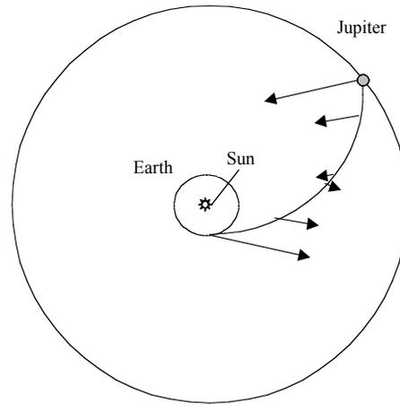
FIGURE 1. CONVENTIONAL CONSTANT LOW THRUST TRAJECTORY FOR JUPITER RENDEZVOUS.
