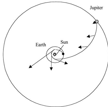
FIGURE 2. LOW-THRUST TRAJECTORY FOR SOLAR-ELECTRIC POWER USING A SOLAR SWINGBY.
